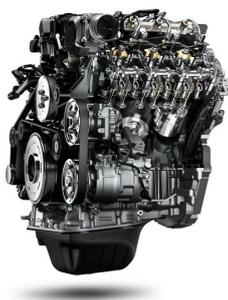
1 Vue du nouveau moteur six cylindres de l'Amarok : le couple est encore augmenté de 130 Nm par rapport au modèle précédent. Le moteur diesel est de plus conforme aux normes sur les gaz d'échappement plus strictes pour les marchés Euro 6.
