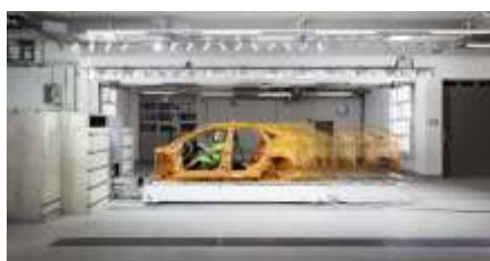
Le cœur du centre de compétences pour la sécurité est le nouveau banc d'essai destiné aux tests à traineau
