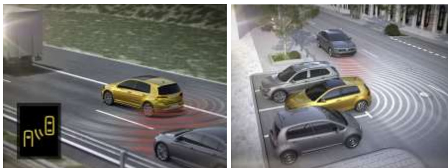
Des capteurs radar surveillent la zone arrière du véhicule
