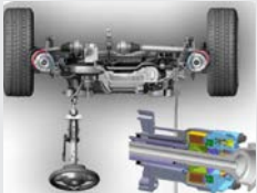
Blocage de différentiel d'essieu avant 'VAQ'
