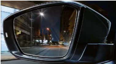
Détecteur d’angle mort ‘Blind spot Detection’
