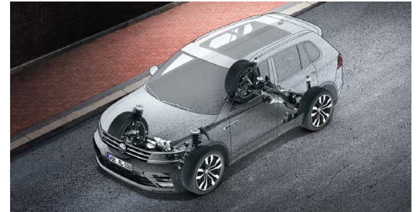
Amortissement piloté DCC
