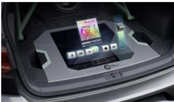
Compact, le module holographique développé par Group Components est équipé de commandes flottantes qui peuvent être utilisées pour commander le système audio.
